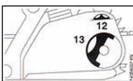
При насаживании крышки цепной звездочки зубья натяжного колеса и натяжного диска должны входить в зацепление с друг другом, при необходимости, 12 = натяжное колесо поверните немного натяжное колесо, пока крышку цепной звездочки можно будет полностью придвинуть к корпусу двигателя
