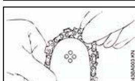
Наденьте защитные перчатки – Опасность травмы острыми режущими зубьями.
