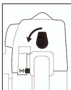
Загрязненные воздушные фильтры снижают мощность двигателя, повышают расход топлива и усложняют пуск устройства.
