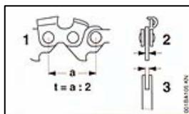
На этой моторной пиле могут применяться пильные цепи с различным шагом – в зависимости от монтируемой цепной звездочки (см. «Технические данные»):
