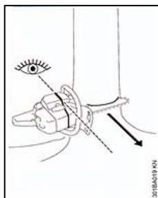
С помощью валочной планки на кожухе и корпусе мотопилы при резании подпила может контролироваться направление валки.
