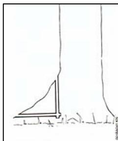
Подпилить большие прикорневые наплывы: первым должен подпиливаться наибольший корневой наплыв – сначала вертикально, затем горизонтально.
