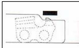
Ограничитель глубины опиливать параллельно нанесенной маркировке.
