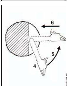
4 = Шину устанавливать нижней, а не верхней стороной вершины – Возможна отдача!
