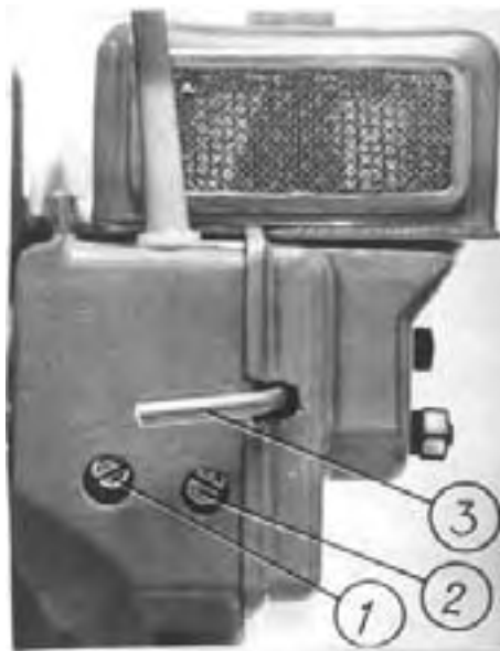
Рисунок 15 – Органы регулировки и управления воздушной заслонкой 1- винт малого газа, 2- винт полного газа, 3- рычаг воздушной заслонки (показан в положении «открыто»)
